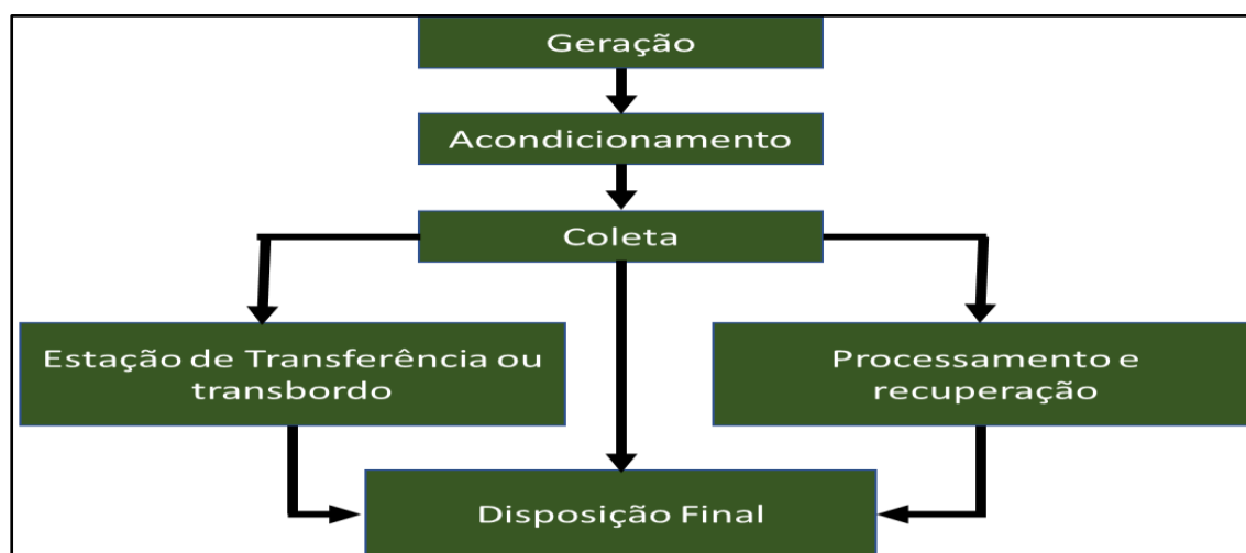
Figura 13. Elementos funcionais do gerenciamento de resíduos sólidos
